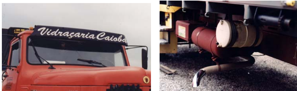
FIGURA 449 - DETALHES EXTERNOS DE UM CAMINHÃO SCANIA 1115, MOSTRANDO ACESSÓRIOS QUE NÃO SÃO ITENS DE SÉRIE: PÁRA-SOL E RESERVATÓRIO DE ÁGUA (BRASIL, 2002)
