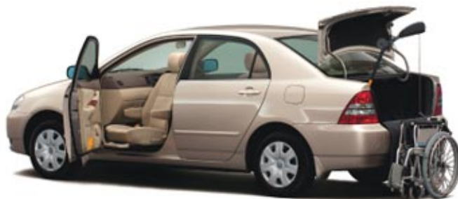
FIGURA 430 - AUTOMÓVEL TOYOTA, COM DISPOSITIVOS DE AUXÍLIO A DEFICIENTES FÍSICOS (JAPÃO, 2003)
